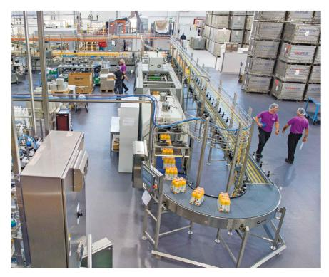
vassoio + film; il sistema automatico di palettizzazione APS 1550 P ERGON e il supervisore di linea SWM. La linea è caratterizzata da elevata flessibilità per passare velocemente da una bottiglia all'altra grazie alla versatilità del forno di riscaldamento preforme della stiro-soffiatrice EBS E ERGON che può lavorare differenti tipi di
