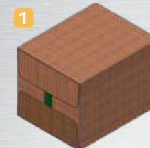
1) Традиционный четырёхклапанный короб (ЧКП)
